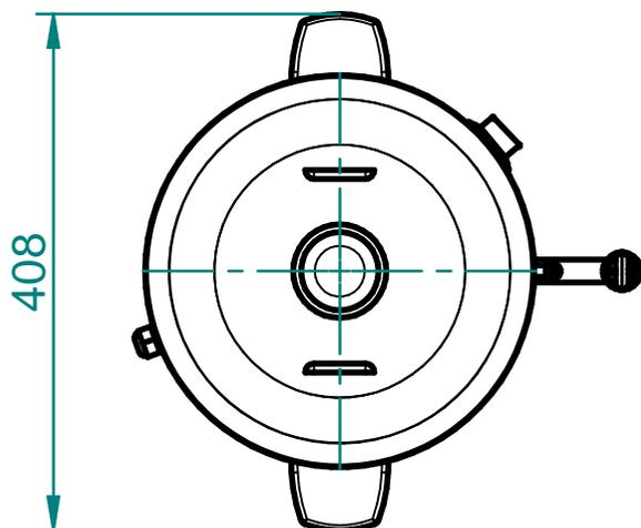
Кипятильник воды электрический КВЭ предназначен для приготовления кипятка на предприятиях общественного питания. Кипятильник оснащен индикатором включения ТЭН-ов, сливным краном и указателем уровня воды, крышкой. Корпус кипятильника, выполнен из нержавеющей стали марки AISI304 толщиной 1 мм.
